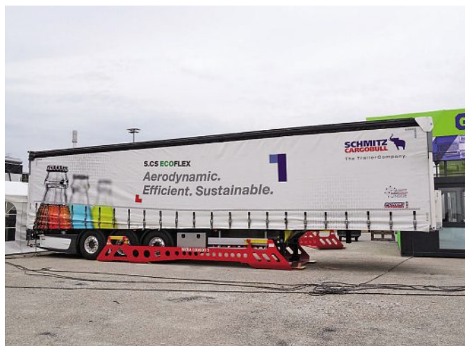
4 Systém NiKRASA pro přepravu standardních návěsů byl vystaven samostatně bez demonstrace nakládky do kapsového vozu.
