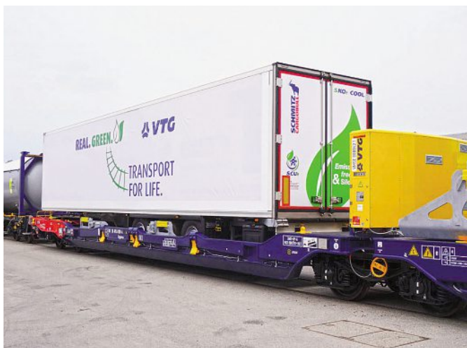
3 Vůz řady Sdggmrss s dobíjecím agregátem firmy SWS Power Solutions pro chladírenské kontejnery.
