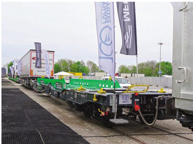
1 Košový vůz Sdggmrss nahradí potřebu zdvihacích přípravků v kapsových vozech
