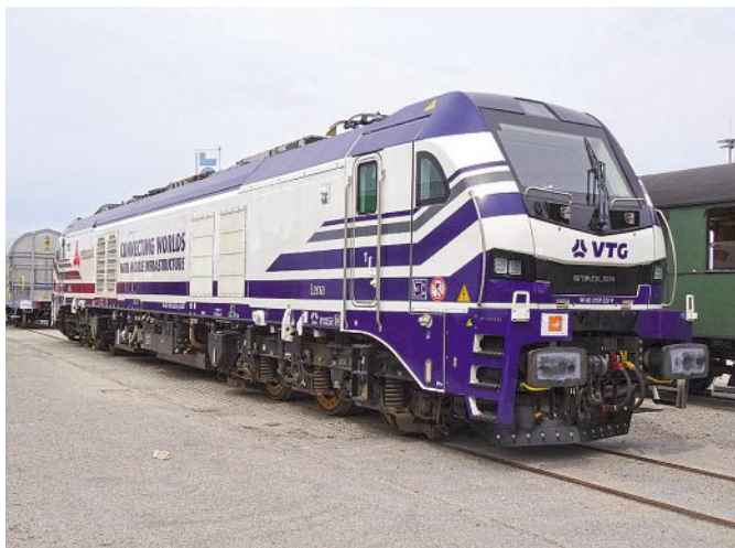
9 Šestinápravová dvouzdrojová Lokomotiva Eurodual od firmy Stadler je určená pro osobní a nákladní dopravu.
