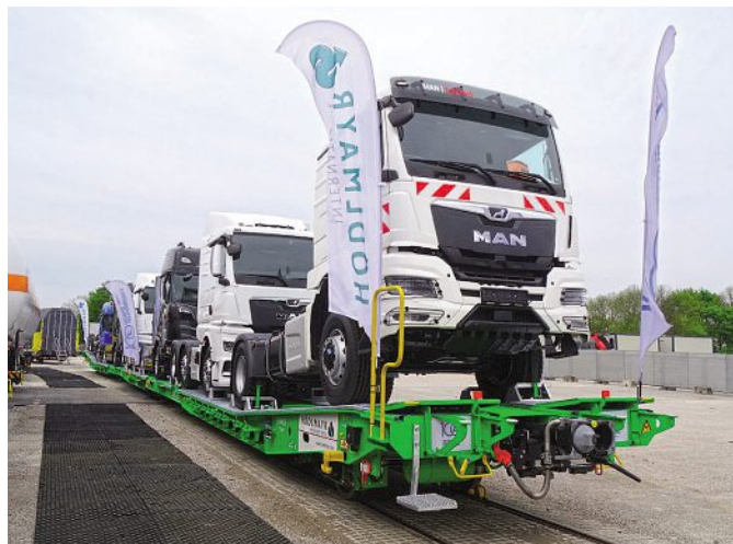
2 Nízkopodlažní článkový vůz Laados pro přepravu užitkových silničních vozidel. Ložná výška nad temenem kolejnice je minimalizována.
