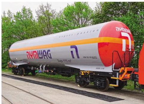
5 Cisternový vůz Zags pro přepravu LPG představený společností Nymwag
