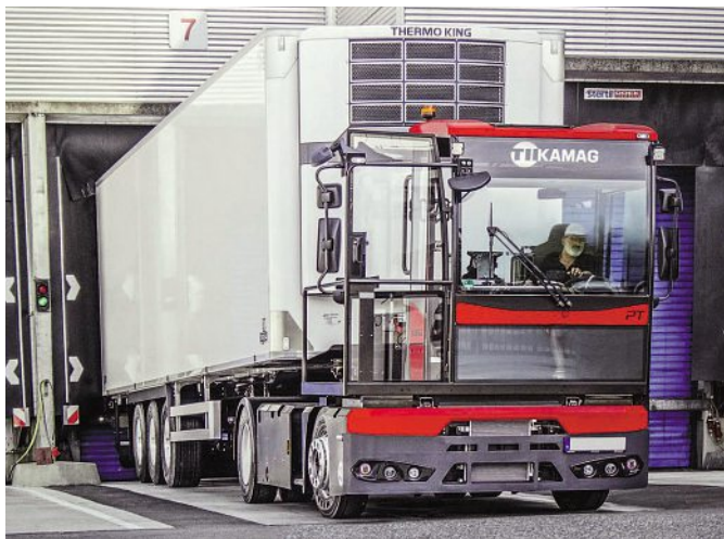
13 Terminálový tahač TII Kamag s hydrostatickým přenosem výkonu má výkon 180 kW, poloměr otáčení 7100 mm a užitečné zatížení 28 tun.
