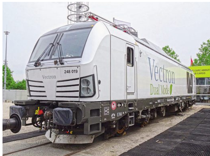
10 Lokomotiva Vectron 248 v duálním provedení. Provozní hmotnost čtyřnápravových strojů je 80 až 87 tun.
