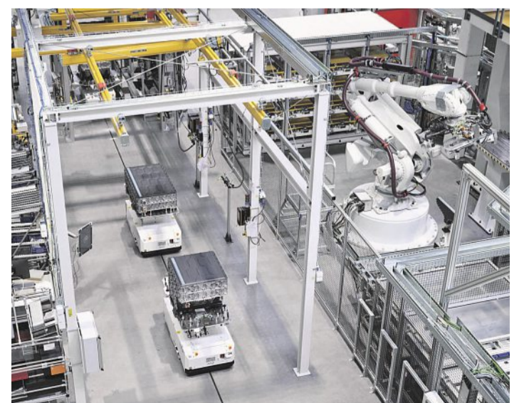
Nákladňky na baterky. Scania chce do roku 2030 prodávat polovinu svých aut s elektrickým pohonem. Na kompletaci baterií z článků od firmy Northvolt otevřela ve výrobním závodě v Södertälje novou halu. Kompletace modulů je plně automatizovaná. Foto: Scania
