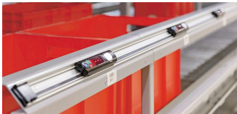
Vizuální prvky doplňují na vychystávacích pozicích barevné pick-to-light lišty pro dokončení vychystávací operace: pracovník uloží požadované zboží do boxu a stisknutím tlačítka potvrdí dokončení vychystávání.
