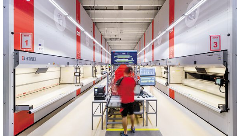
Vstupní pracoviště, které slouží k párování přepravních štítků s čárovým kódem přepravky.
