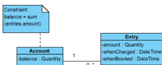
Obrázek 4.5.1: Schéma vzoru Účet .
