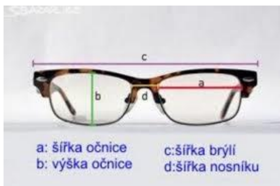
Obrázek č. 4 (Popis parametrů oobrubu) [ http://www.vyhodne-bryle.cz/info/cisla-na-vnitri-strane-obrubu.html ]
