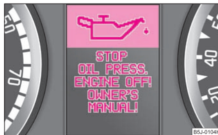
Obr. 13 Informační displej: nízký tlak oleje
