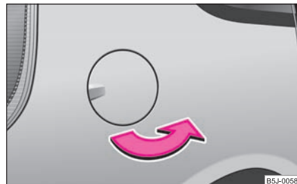
Obr. 152 Boční strana vozidla vpravo vzadu: kryt hrdla
