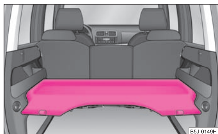
Obr. 64 Kryt zavazadlového prostoru v dolní poloze
