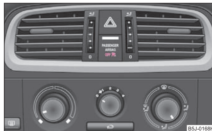
Obr. 134 Kontrolní světlo vypnutého airbagu spolujezdce
