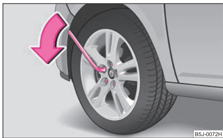
Obr. 172 Výměna kola: povolení šroubů
