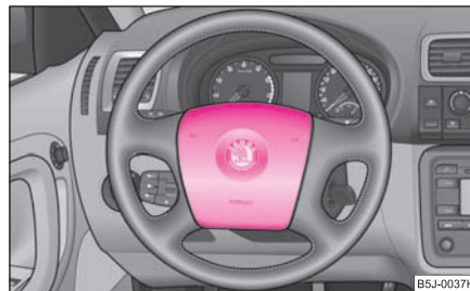
Obr. 125 Airbag řídiče ve volantu
