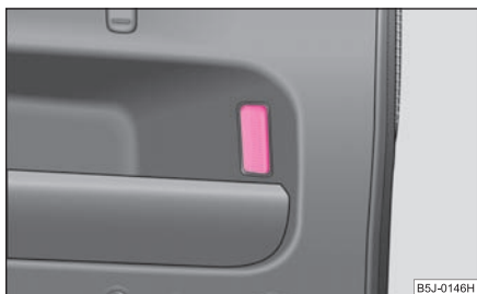
Obr. 195 Demontáž osvětlení zavazadlového prostoru
