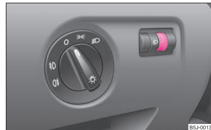
Obr. 34 Přístrojová deska: nastavení sklonu světlometů
