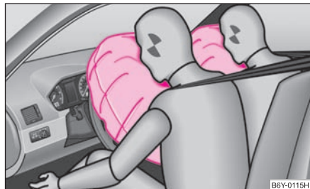
Obr. 127 Plynem naplněné airbagy
