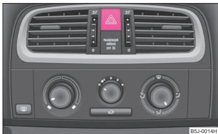
Obr. 35 Přístrojová deska: spínač varovných světel
