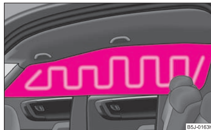
Obr. 132 Hlavový airbag naplněný plynem
