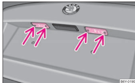
Obr. 190 Demontáž osvětlení registrační značky
