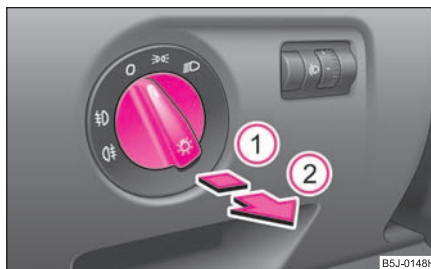
Obr. 33 Přístrojová deska: spínač světel
