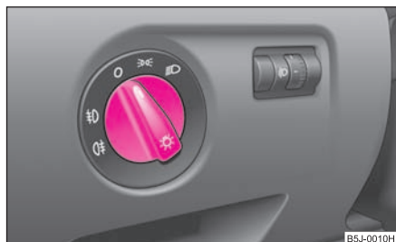
Obr. 31 Přístrojová deska: spínač světel
