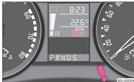
Obr. 3 Displej: počítadlo ujeté vzdálenosti
