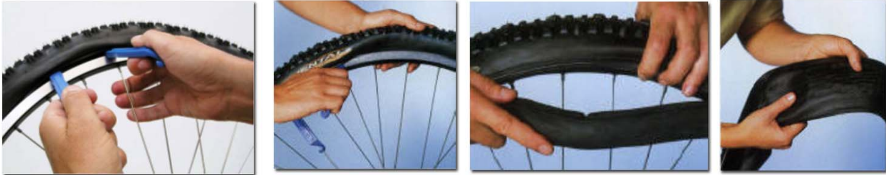
obr. IV/10 – Postup při lepení duše, zdroj:[2]
