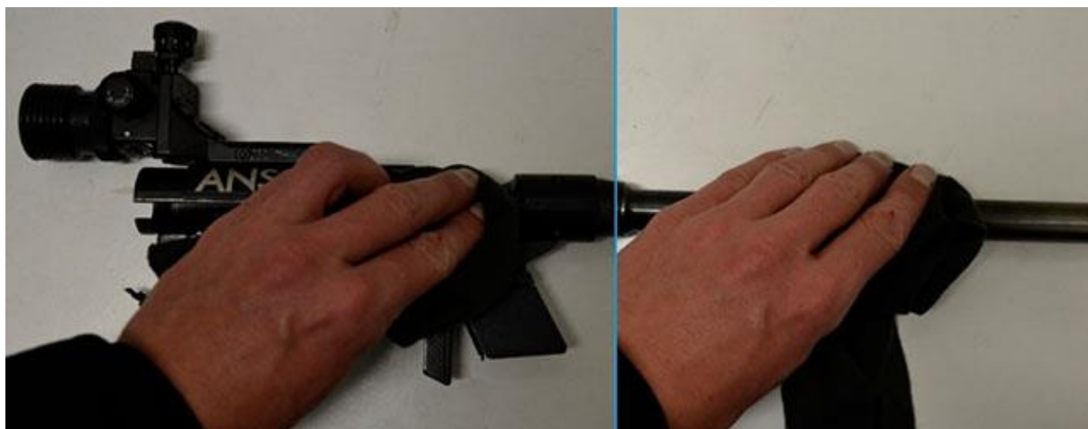
Obr. 95 Údržba vnějších částí zbraně pomocí hadru
