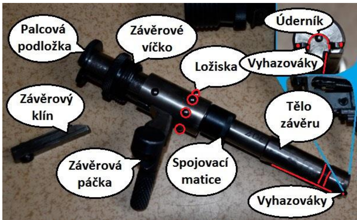
Obr. 96 Čištění závěru a jeho částí
