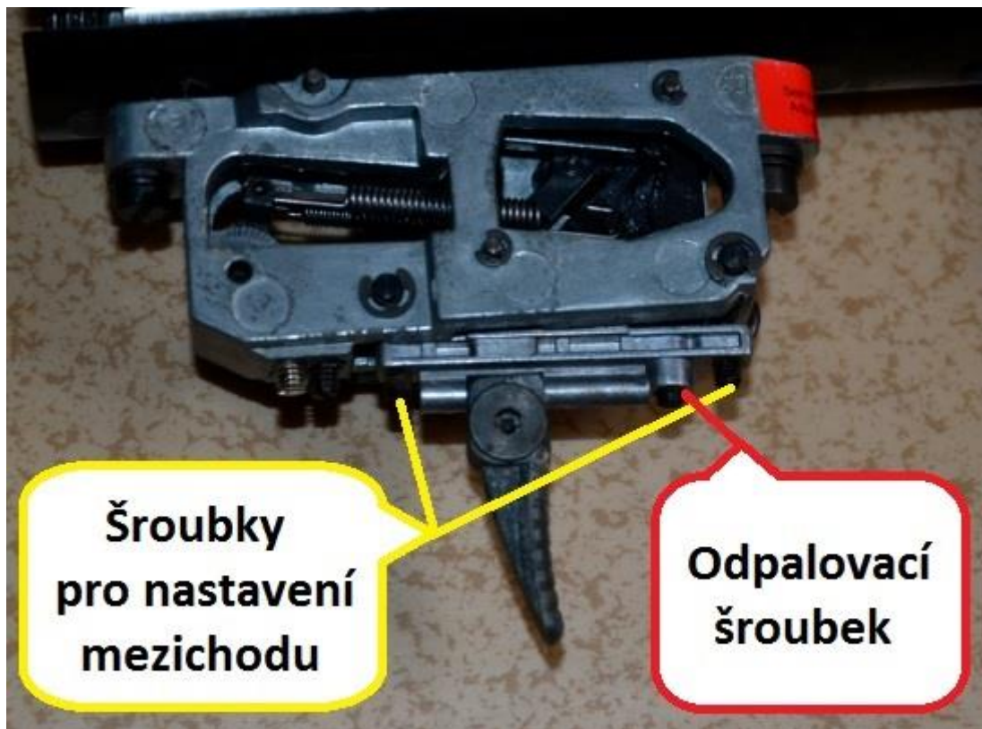
Obr. 21 Šroubky pro nastavení mezichodu a odpálení spouště
