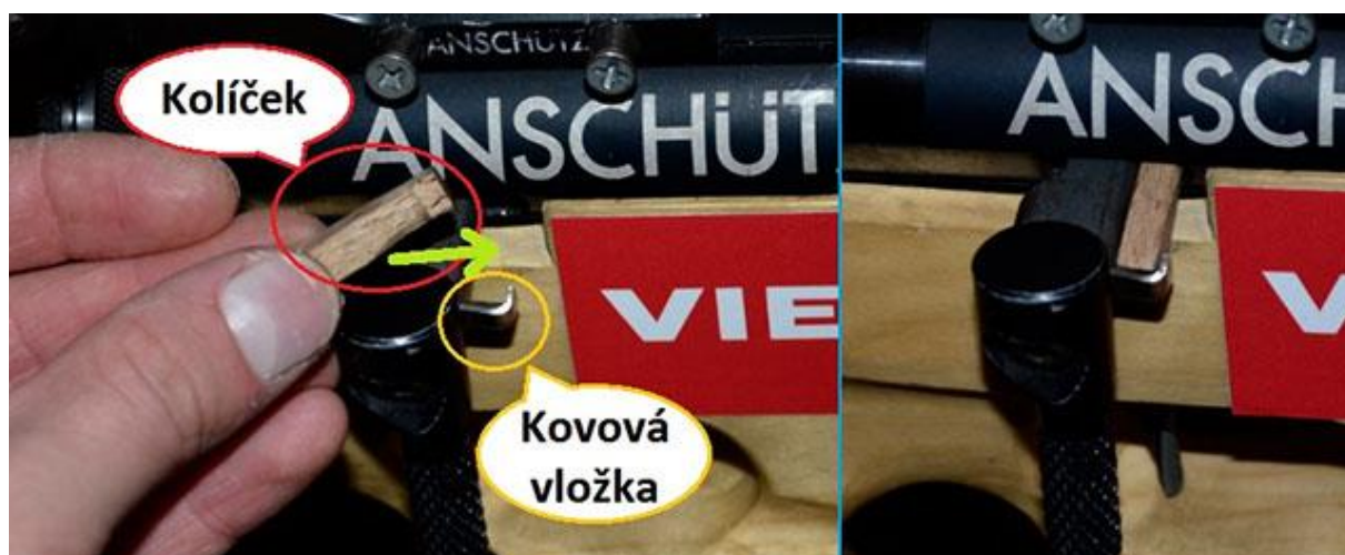
Obr. 60 Kolíček s kovovou vložkou pro suchou střelbu/ umístění kolíčku ve vložce
