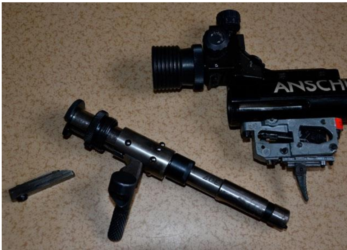
Obr. 90 Vyjmutý závěr s demontovaným závěrovým klínem
