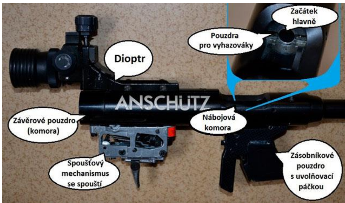
Obr. 3 Zadní část hlavně s popisky
