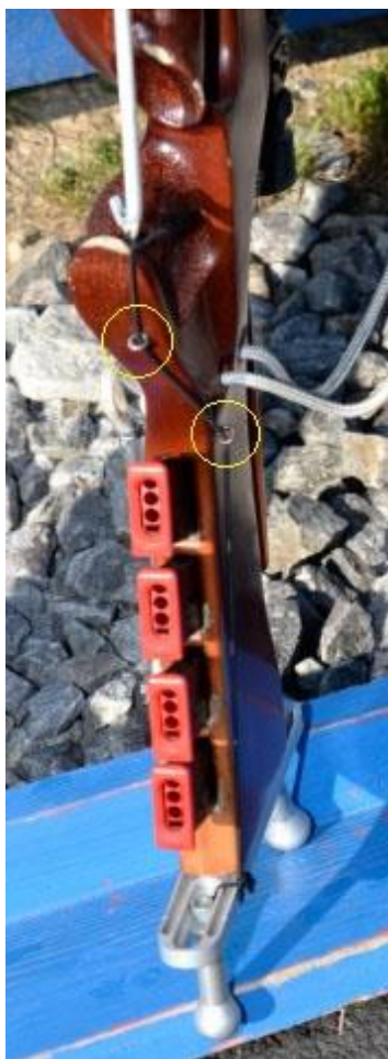
Obr. 11 Vedení gumy od háku upínacího řemene skrze očka k botce
