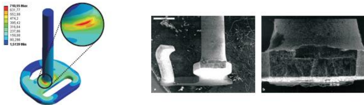
Obr. 62. Vizualizace lokalizace maximálních hodnot modelového redukovaného napětí v krčku implantátu při simulovaném zatížení implantátu silou 190 N (vlevo, upraveno dle Marcián et al. (2009). Detail lomu v krčkové části diskového implantátu (převzato z Ihde 2004).
