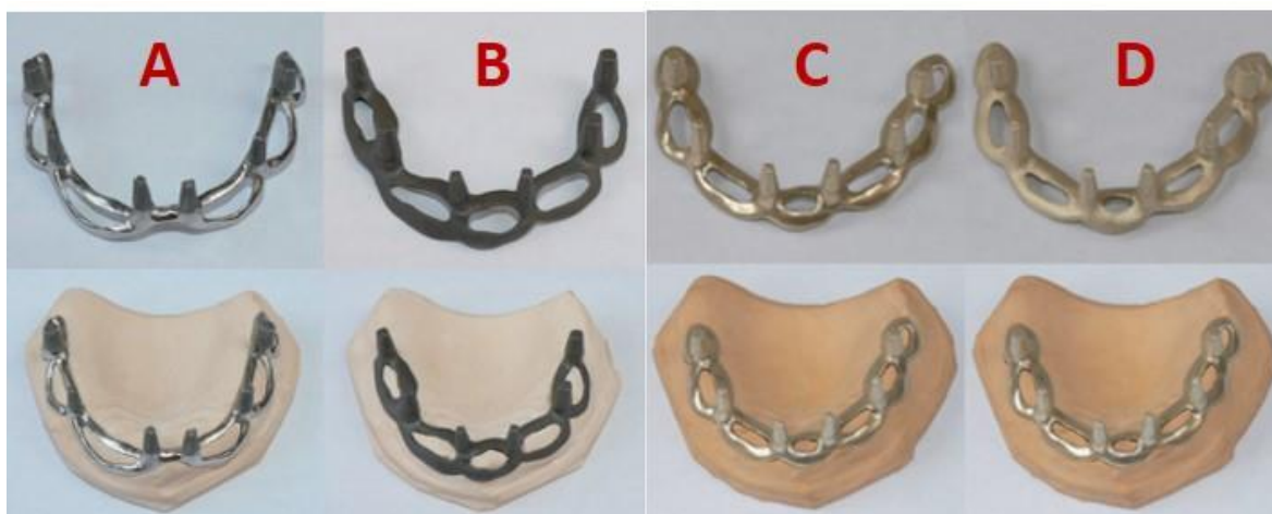
Obr. 29. Nepovlakovaný implantát: (A) leštěný, (B) drsný, implantát povlakovaný vrstvou ZrN: (C) leštěný, (D) drsný. Upraveno dle Bartáková et al. (2007).
