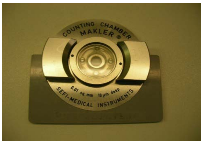
Obr. 31: Maklerova komůrka k hodnocení spermiogramu
