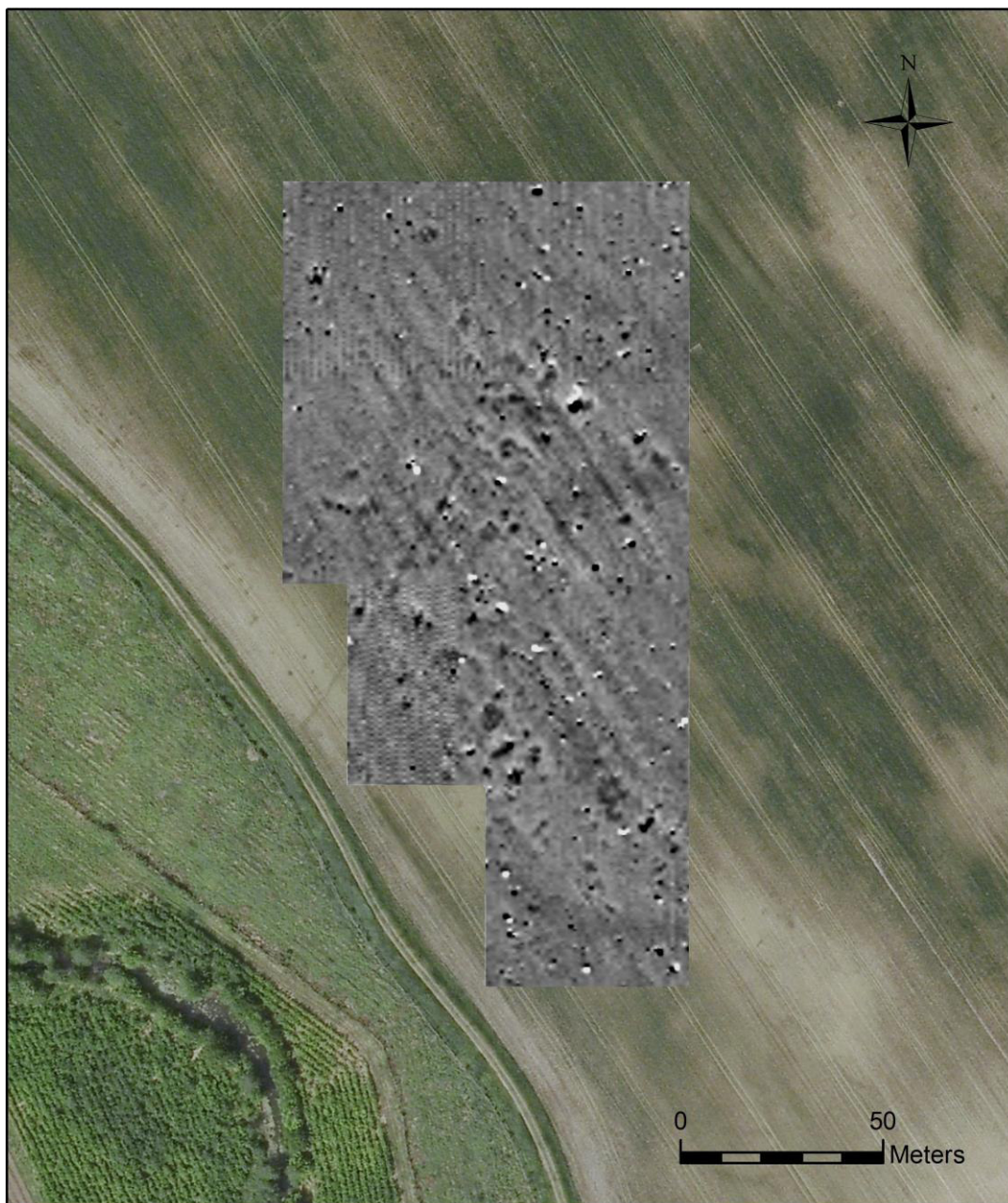
Obr. 160. Kostice – Zadní hrád 2. Magnetogram, céziový magnetometer SM-5 Navmag Scintrex, dynamika nameraných hodnôt -2/+2 nT v 256 stupňoch šedej škály (biela/čierna), raster 0,10 m/1,00 m.
