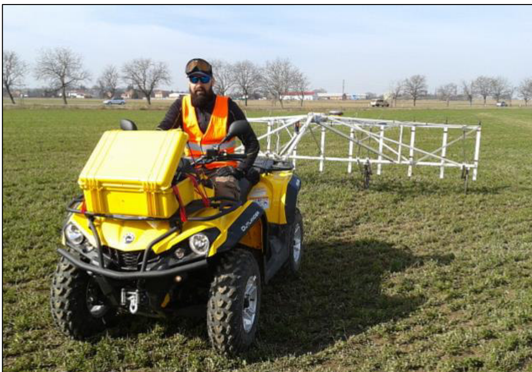
Obr. 2. Multisenzorový magnetometer v ATV móde, využívaný na veľkoplošný prieskum archeologických lokalít.
