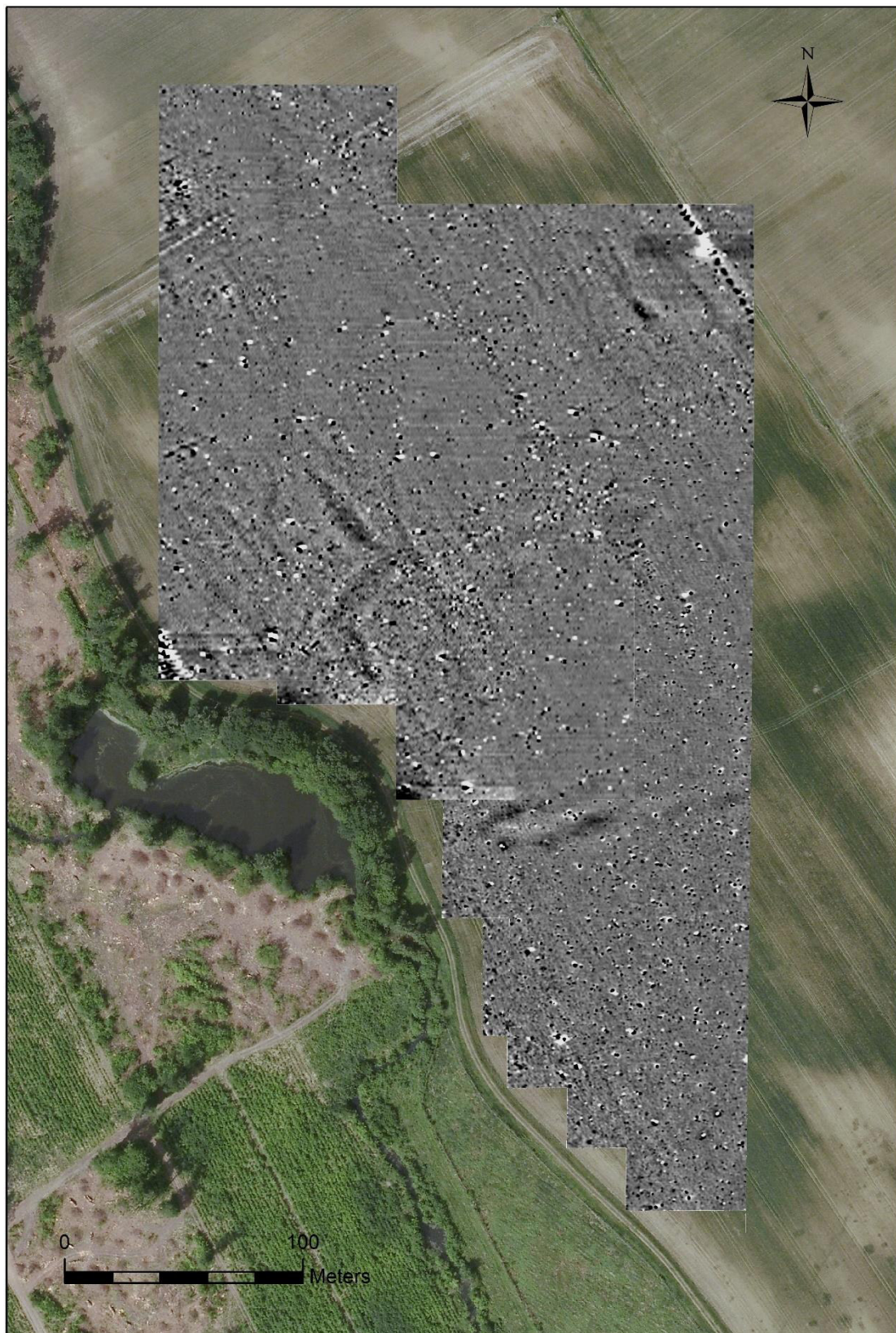
Obr. 27. Kostice – Zadní hrúd 1. Magnetogram, céziový magnetometer SM-5 Navmag Scintrex, raster 0,10 m/1,00 m a fluxgate-gradiometer Förster Ferex 4.032 DLG, raster 0,25 m/0,50 m, dynamika nameraných hodnôt -2/+2 nT v 256 stupňoch šedej škály (biela/čierna).
