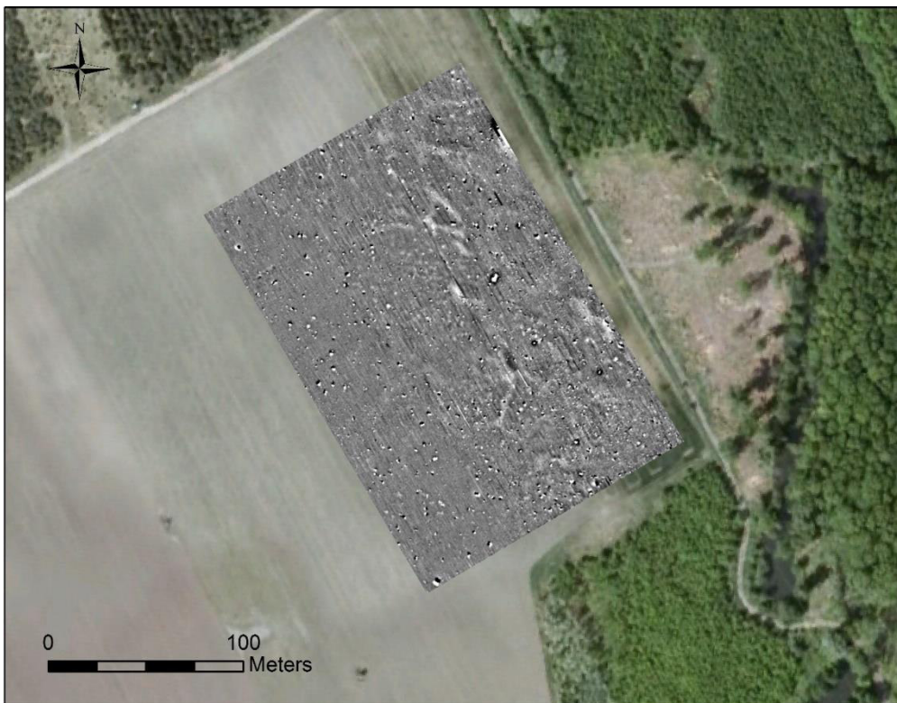
Obr. 33. Břeclav - Libivá. Magnetogram. Fluxgategradiometer Förster Ferex 4.032 (-3/+3 nT, čierna/biela).
