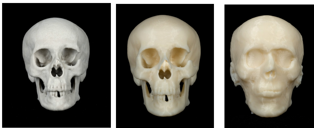
Obr. 5. Ukázka technologie 3D tisku použitá na vytvoření fyzického modelu lebky a hlavy lidské mumie. Zcela vlevo je prezentován tisk pomocí technologie Z-Corporation, uprostřed a vpravo se jedná o technologii ABS polymerů.
