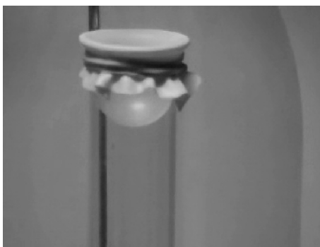
Obrázek 17. Blána prohnutá přetlakem
