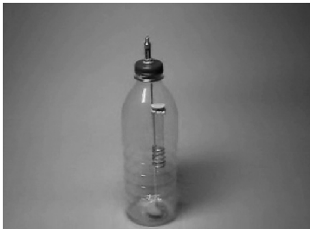
Obrázek 16. Zkumavka s blánou v láhvi
