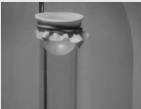
Obrázek 17. Blána prohnutá přetlakem
