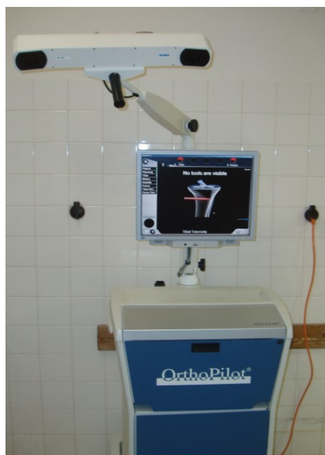
Obr.6 - navigační systém pro zjištění rotační stability kloubu OrthoPilot
