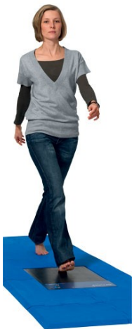
Obr. 12: zapuštění plošiny emed do lávky (viz http://www.novel.de/pdf/flyer/eng/emedX_eng.pdf )
