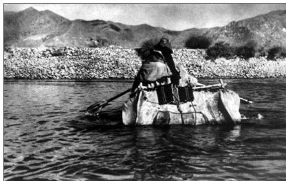
Obr. 20. Přeprava po řece Cangpo se děje na primitivních loďkách, jejichž kostru tvoří ohebné pruty potažené jačími kožemi sešitými dohromady.
