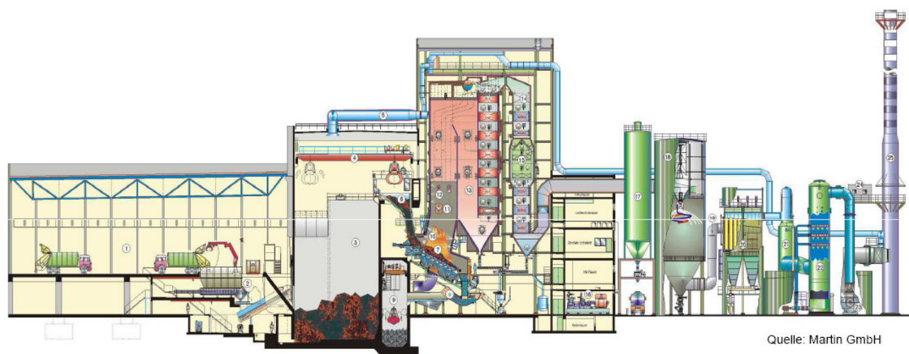
Obr. č. 1: Funkční schéma spalovny KO v Německu
