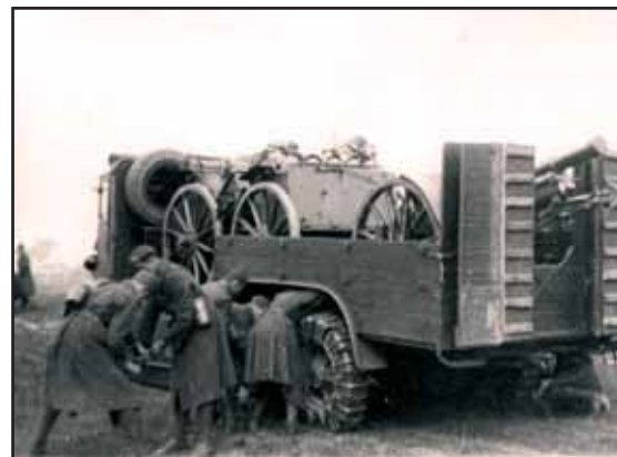
Speciální dělový automobil vz. 29 z produkce automobilky Tatra. Na korbě tohoto výkonného a konstrukčně zdařilého vozidla je naložena lehká houfnice vz. 14/19 ráže 10 cm. Zobrazený vůz symbolizoval počátky motorizace dělostřeleckých útvarů (30. léta).
