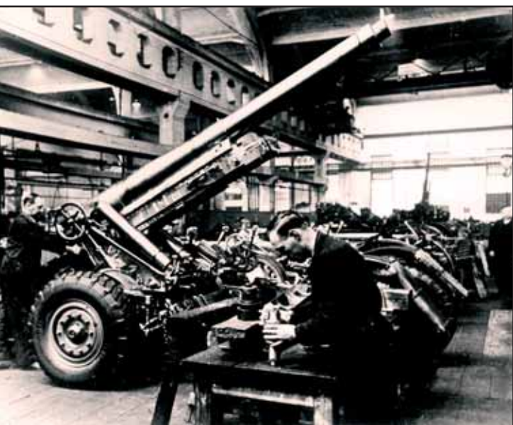
Montáž 15cm hrubých houfnic vz. 37 ve Škodových závodech v Plzni. Tato dělostřelecká zbraň tvořila součást výzbrojního programu čs. armády, ale k jednotkám se do likvidace armády v roce 1939 již nedostala.
