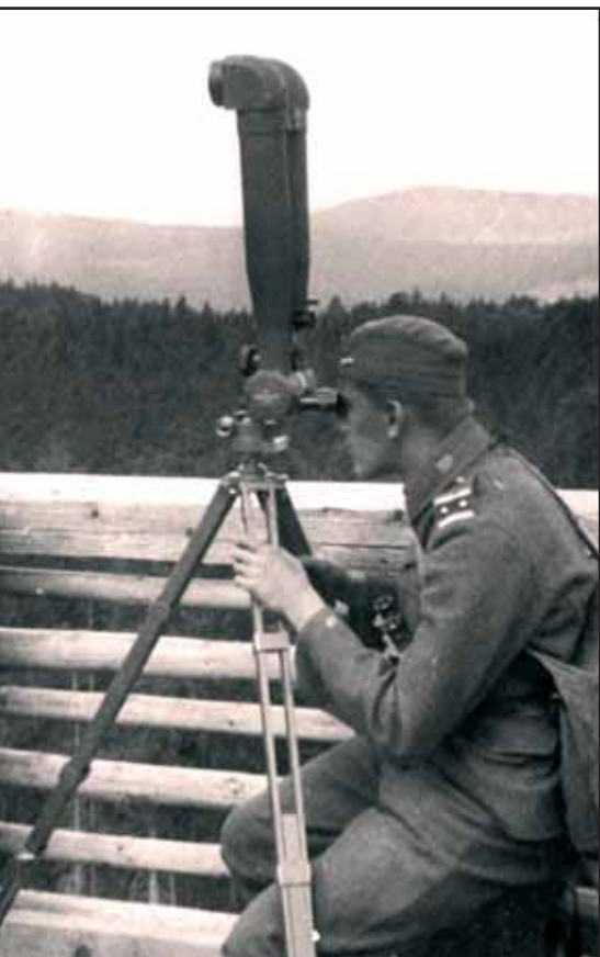
Československá armáda obdržela v meziválečném období vysoce kvalitní optické přístroje. Patřil k nim i vynikající úhlový dalekohled vz. 17, který se vyznačoval patnáctinásobným zvětšením (30. léta).
