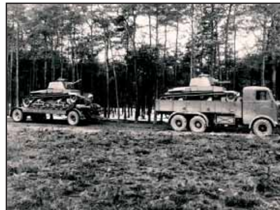
Prototyp 10t nákladního automobilu Škoda 6VT6-T s lehkým tankem vz. 35
