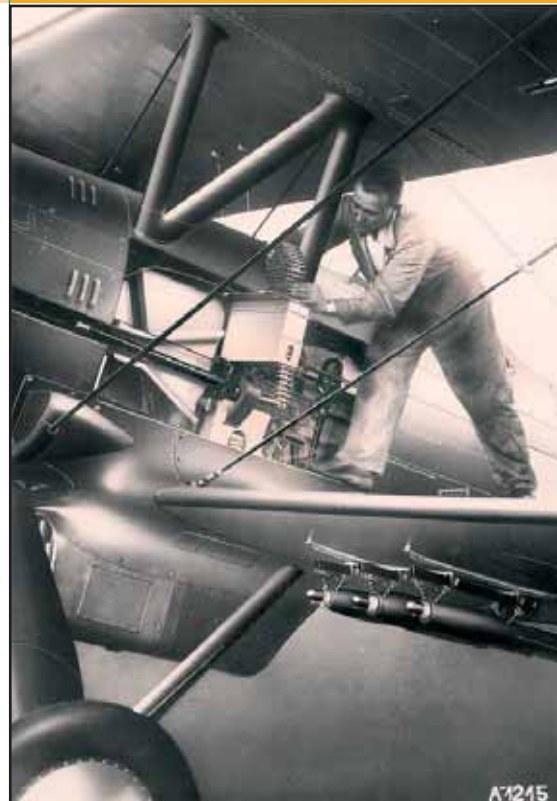
Doplňování střeliva pro jeden z leteckých kulometů vz. 30 ráže 7,92 cm (výrobce Česká zbrojovka a. s. Strakonice) stíhacího letounu Avia B-534
