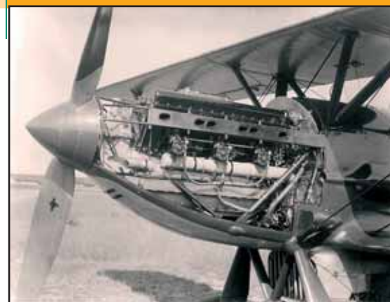
Odkrytý motorový prostor stíhacího letounu Avia B-534 s šestiválcovým motorem Hispano Suiza 12Ydrs
