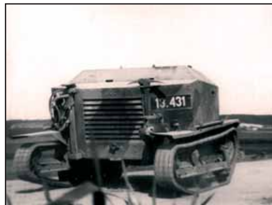
Dynamický snímek jedoucího tančíku Tč vz. 33. Tento typ bojového vozidla pocházel z produkce ČKD Praha.
