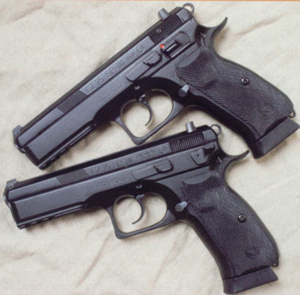
CZ 75 SP-01 s hliníkovým tělem je vybavena manuální pojistkou (nahore), CZ 75 SP-01 Tactical s hliníkovým tělem má vypouštěcí páku (dole)
