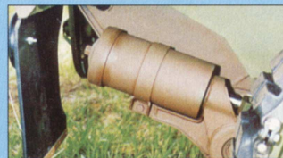
Detail napínacího mechanismu posledního pojezdového kola
