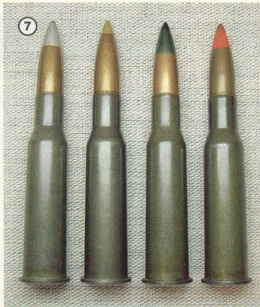
Náboje 7,62-59 (7,62x54R) - zleva střela s jádrem z měkké oceli (stříbrný hrot), těžká střela s olověným jádrem (žlutý hrot), svítící (zelený hrot) a zápalná (červený hrot)
