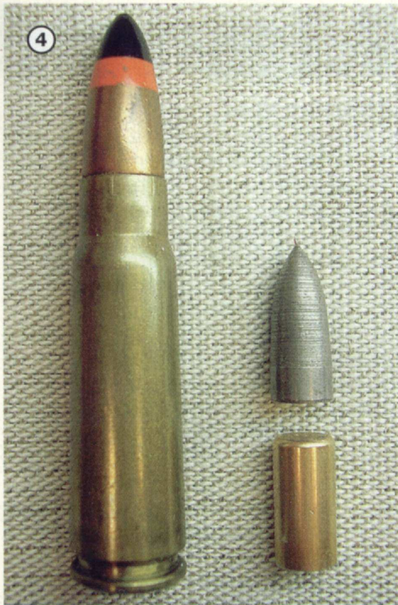
Náboj 7,62-Pz-43 (7,62x39) s průbojně zápalnou střelou a obsah průbojně zápalné trasovací střely 7,92 mm Mauser (8x57), slož je ve válečku
