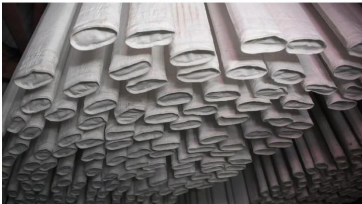
Látkové hadice z mikrovláken na zachycení prachu v elektrárně Chvaletice (Zdroj: oenergetice.cz)
