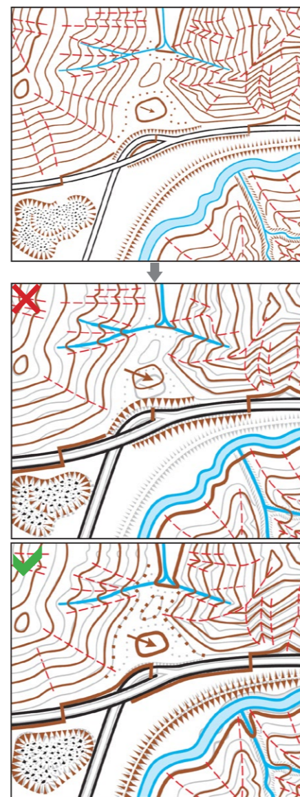
Obr. 7.29 – Generalizace vrstevnic (původní data v měřítku 1 : 25 000, generalizovaná 1 : 50 000 – zvětšeno). Správná generalizace vyhladila vrstevnice, zachovala charakteristickou strukturu a tvary reliéfu. [převzato ze SPIESS ET AL. 2005]
