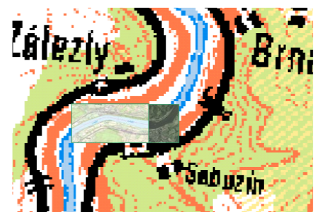
Obr. 7.22 – Posun prvků: mapa v měřítku 1 : 500 000 ve srovnání s ortofotem a mapou 1 : 10 000.
