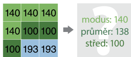
Obr. 2.5 – Možnosti přiřazení nové hodnoty pixelu při zmenšení rastru.
