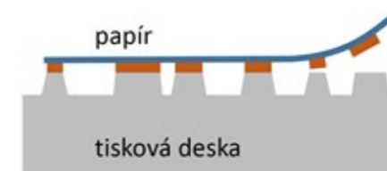
Obr. 11.6 – Princip tisku z výšky.
