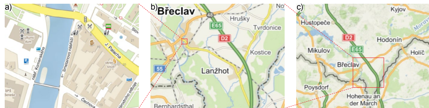
Obr. 74 – Proces abstrakce: a) na mapě velkého měřítká je areálovou značkou i řeka Dyje; b) na mapě středního měřítká je město znázorněno již značkou areálovou, značka řeky zůstává liniová; c) na mapě malého měřítká je město Břeclav znázorněno bodovou značkou, řeka Dyje liniovou. [Mapy.cz]
