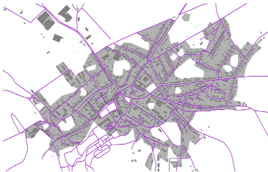
Obr. 7.34 – Ukázka generalizace zastavěné oblasti pomocí funkce Delineate Built-Up areas (fialově vrstva silnic, tmavou šedou vstupní vrstva budov, světlou šedou generaliovaný obraz zástavby).
