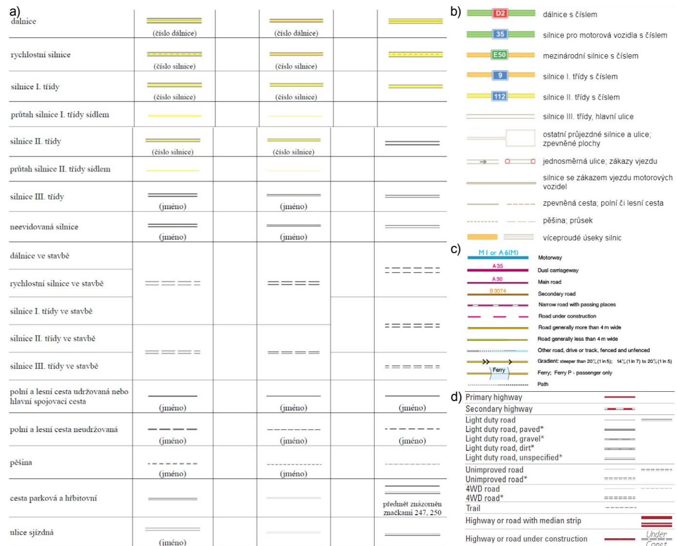
Obr. 4.26 – Příklad mapových značek pro silnice a cesty u topogr. map ČÚZK (a), mapy.cz (b), UK Ordnance Survey (c) a USGS (d).
