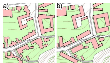
Obr. 7.18 – Zjednodušení polygonů na příkladu budov: a) původní data, b) generalizovaná data. [převzato z BAYER 2008]
