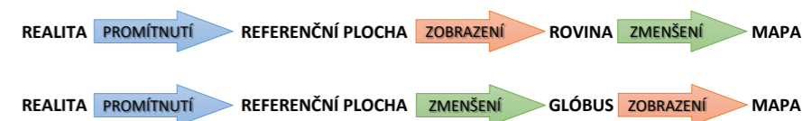
Obr. 1.8 – Schematické znázornění postupů vzniku mapy pro definici měřítka.
