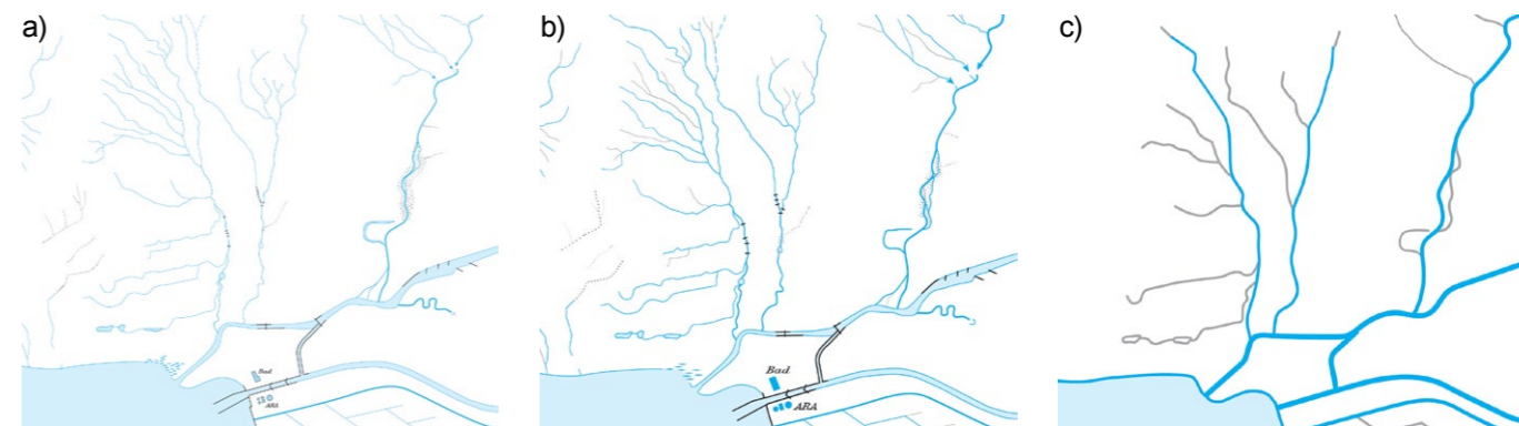
Obr. 77 – Výběr řek pro mapu v měřítku 1:25 000 (a), 1:50 000 (b) a 1:200 000 (c). [převzato ze SPIESS ET AL. 2005]
