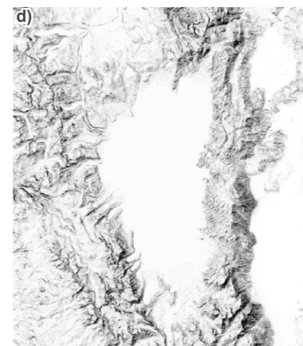
Obr. 5.37 – Stínování vytvořené v ArcGIS a) standardní metodou, b) Multidirectional Hillshade, c) Swiss Hillshade, d) Cluster Hillshade (varianta Elevation), e) Sky Model a f) Shadow lines. [převzato z FIELD & BEALE 2016]
