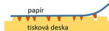
Obr. 11.9 – Princip tisku z hloubky.
