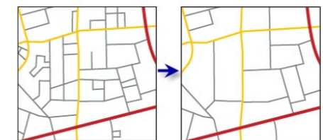
Obr. 7.38 – Ukázka zjednodušování obrazu silniční sítě pomocí funkce Thin Road Network . [ESRI]
