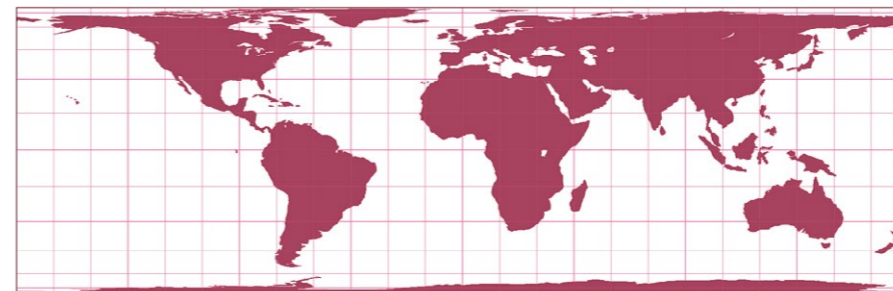
Obr. 3.8 – Lambertovo válcové zobrazení. [převzato z JUNG 2008b]
