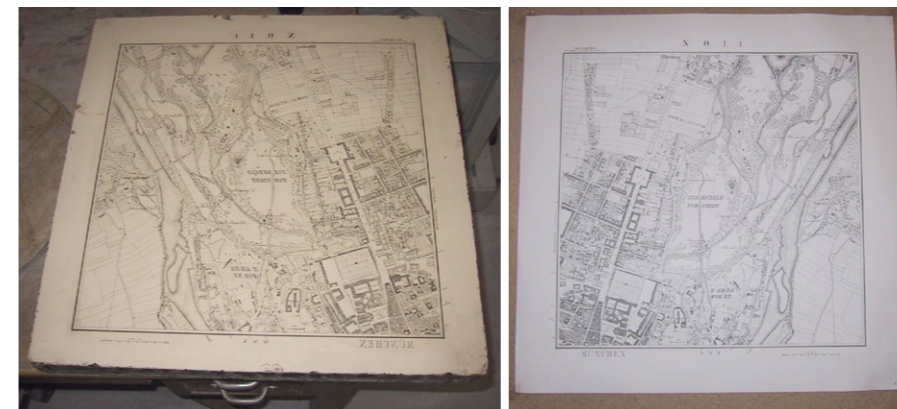
Obr. 11.11 – Kamenná tisková deska a vytištěná mapa [Wikipedia].
