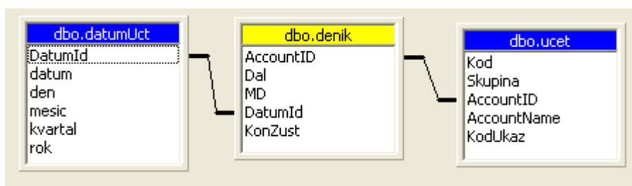
Obr.č.7 Příklad hvězdicového schématu (žlutě tabulka faktů)
