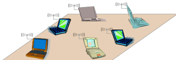
Figure: Jednoduchý příklad: notebooky v konferenční místnosti – tzv. single-hop ad-hoc síť (všechny síťové uzly jsou navzájem v dosahu přímé komunikace).
