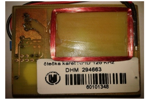
RFID reader 125kHz
