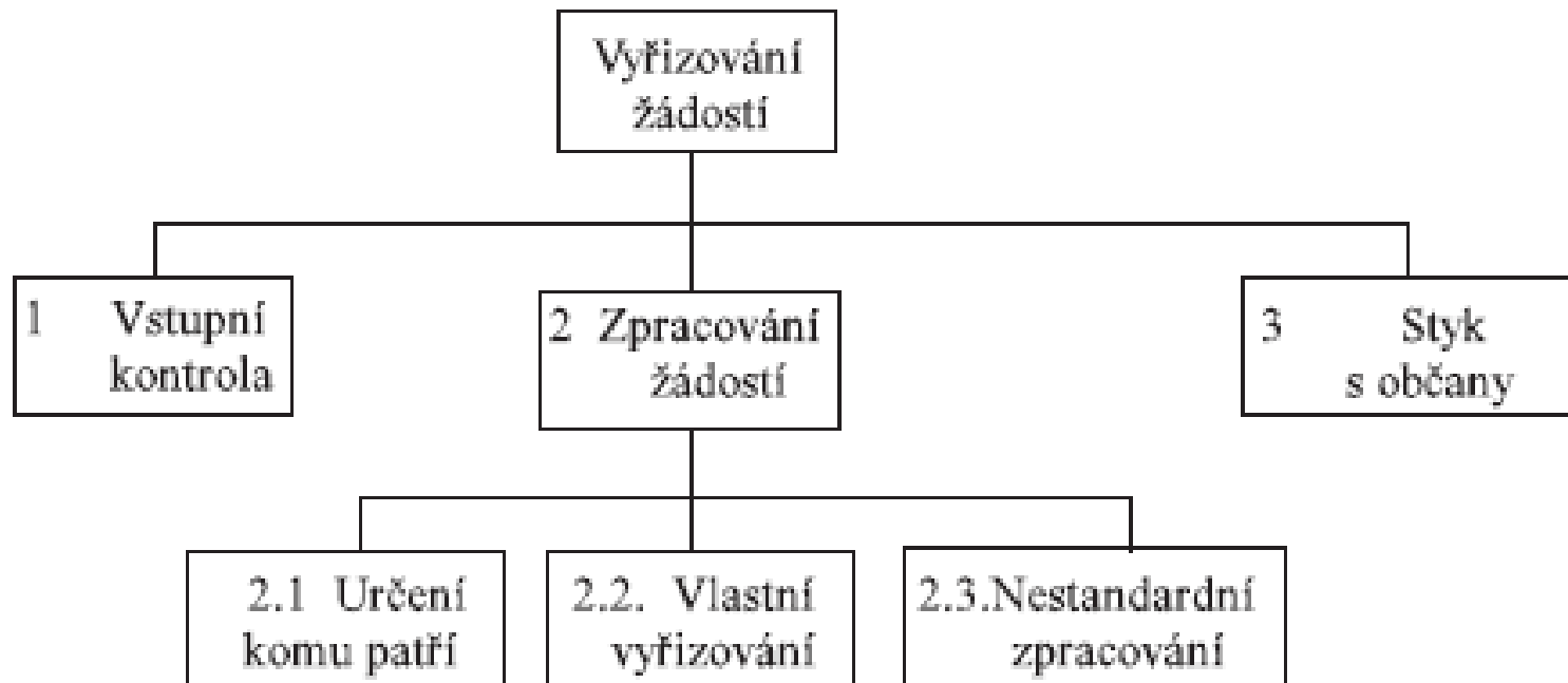
Obr. 12.11: Hierarchie vytvořená postupnou dekompozicí systému Zpracování žádostí.
