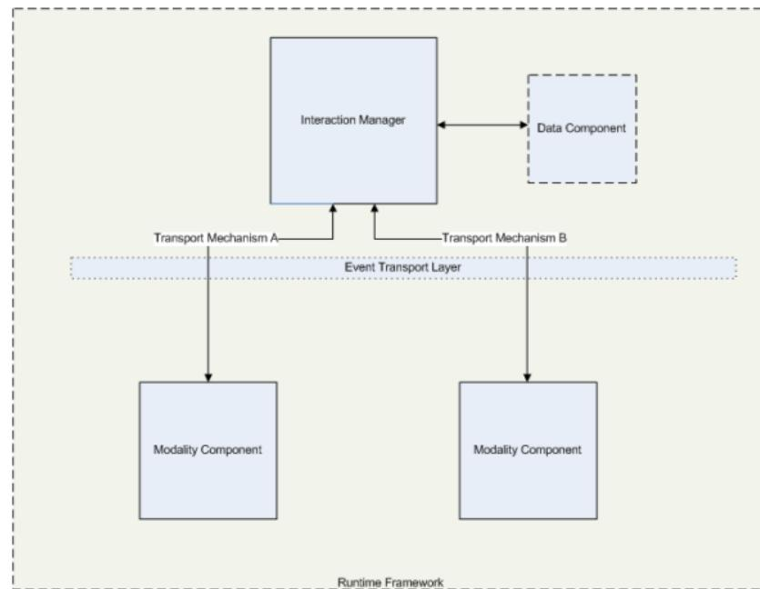
Obrázek: Návrh architektury multimodálního systému (převzato ze specifikace W3C)
