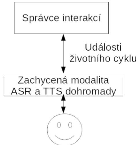
Obrázek: Ukázka komplexní modalitní komponenty (převzato ze specifikace Multimodal Architecture and Interfaces)
