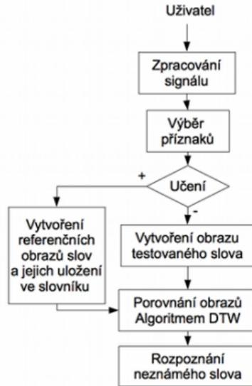
Obrázek: Blokové schéma klasifikátoru slov
