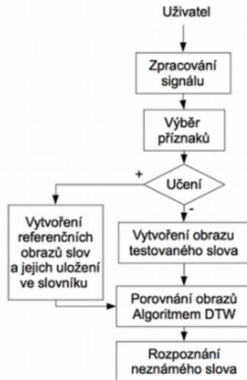
Obrázek: Blokové schéma klasifikátoru slov
