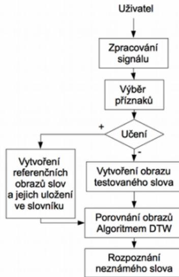
Obrázek: Blokové schéma klasifikátoru slov
