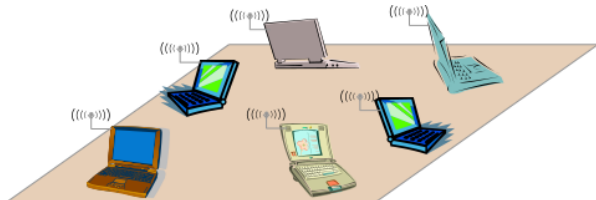
Figure: Jednoduchý příklad: notebooky v konferenční místnosti – tzv. single-hop ad-hoc sítě (všechny síťové uzly jsou navzájem v dosahu přímé komunikace).
