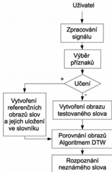
Obrázek: Blokové schéma klasifikátoru slov
