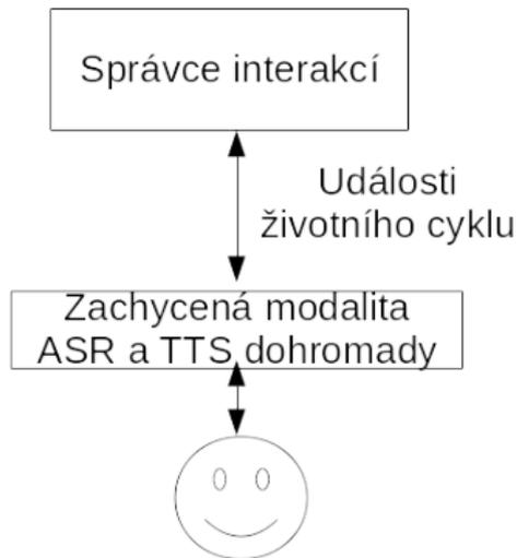
**Obrázek:** Ukázka komplexní modalitní komponenty (převzato ze specifikace Multimodal Architecture and Interfaces)
