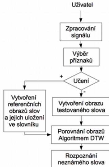
Obrázek: Blokové schéma klasifikátoru slov
