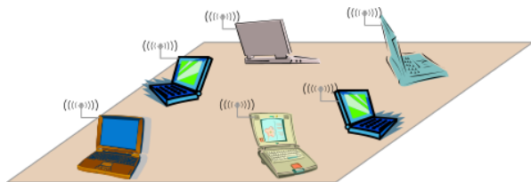
Figure: Jednoduchý příklad: notebooky v konferenční místnosti – tzv. single-hop ad-hoc sítě (všechny síťové uzly jsou navzájem v dosahu přímé komunikace).
