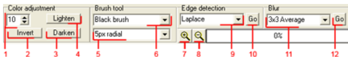
Obrázek 3.3: Ukázka horizontální pracovní lišty, detail nástrojů: 1)Stupeň intenzity 2)Tlačítko zesvětlení 3)Tlačítko ztmavení 4)Tlačítko inverze 5)Velikosti štětce 6)Barva štětce 7)Přiblížení 8)Oddálení 9)Typ hranového filtru 10)Hledání hran 11)Typ rozmazávacího filtru 12)Rozmazání
