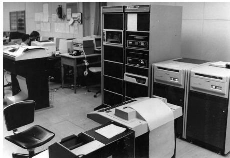
Celkový pohled na PDP-11/34
