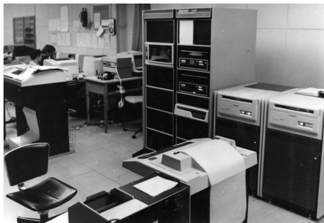
Celkový pohled na PDP-11/34
