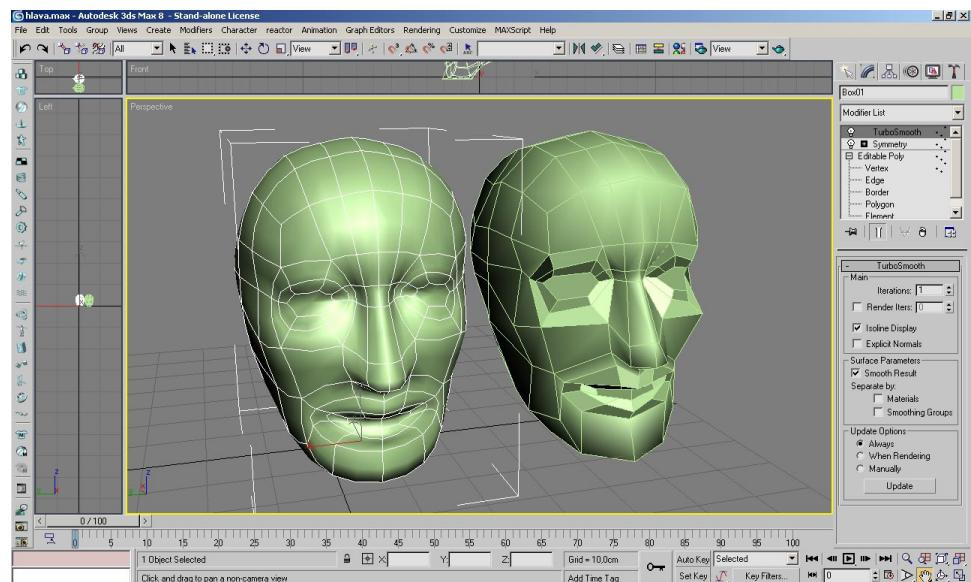
Začátek modelování (z výše uvedeného příkladu). Co nejdříve si definuji základní tvary pomocí správně definovaných hran.
