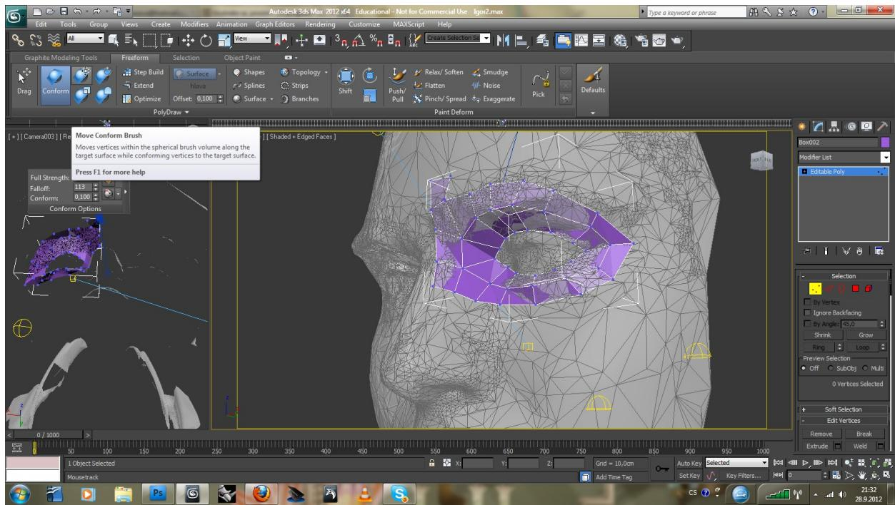
Doporučuji si zprůhlednit sken (**Alt+X**) a přepnout zobrazení Viewportu na *Shaded* a *Edged Faces*.
