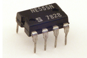
NE555 – neznámější integrovaný obvod Zdroj: http://en.wikipedia.org
