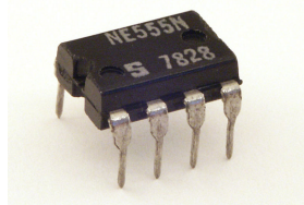
NE555 – neznámější integrovaný obvod Zdroj: http://en.wikipedia.org
