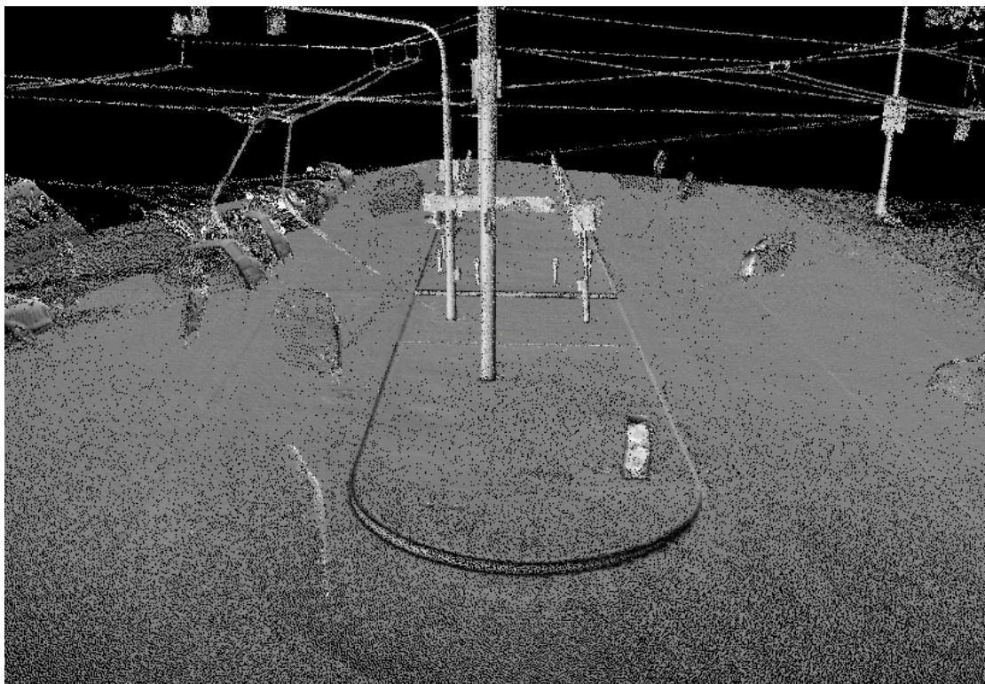
Zobrazení mračna bodů obarveného podle úhlu normálových vektorů
