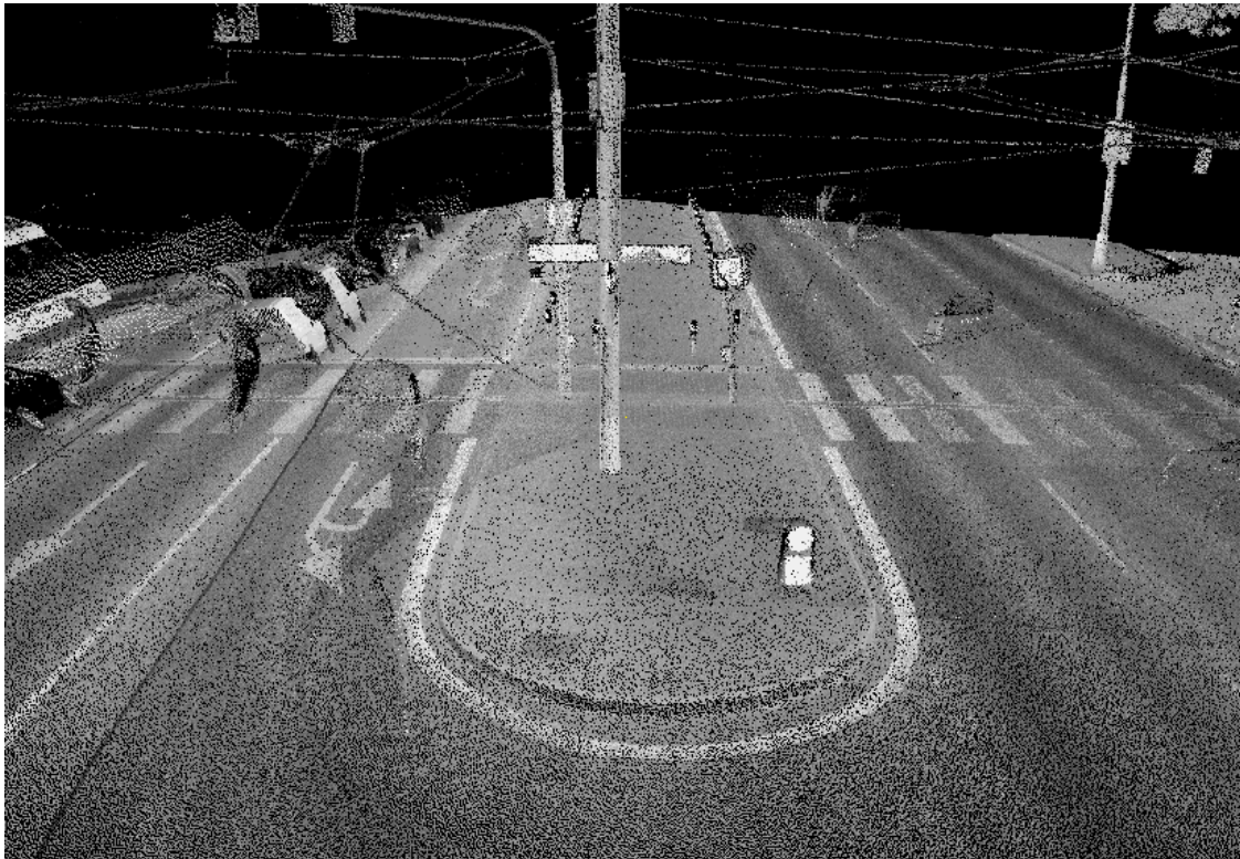
Zobrazení mračna bodů podle intezity odrazu v centrální projekci
