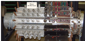
Zpoždovací linka počítače UNIVAC I Zdroj: http://en.wikipedia.org
