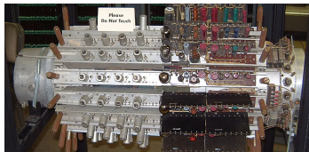
Zpoždovací linka počítače UNIVAC I Zdroj: http://en.wikipedia.org
