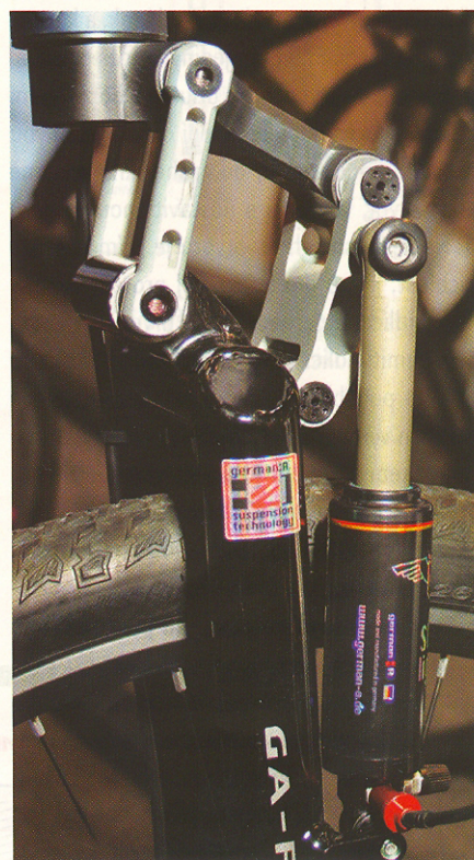
Jedno z možných provedení paralelogramové (kloubové) vidlice.
