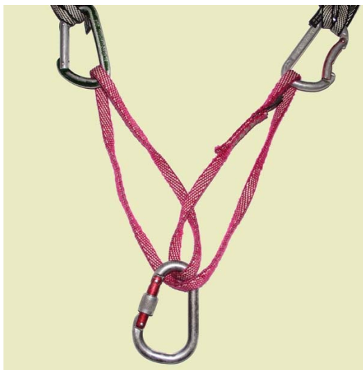
Obr. 53. Spojení dvou bodů pomocí smyčky s překrutem.
