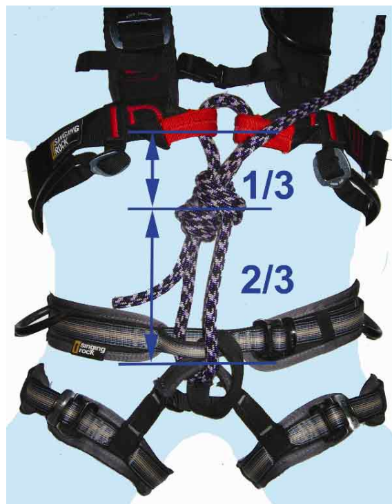
Obr. 15. Navázání na kombinovaný úvaz přímo na lano pomocí propíchnutého vůdcového uzlu.
