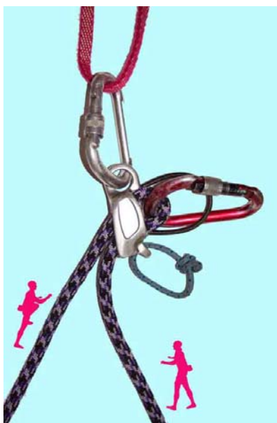
Obr. 41. Založení jisticí pomůcky ATC Guide v blokačním režimu dobírání druholezce.
