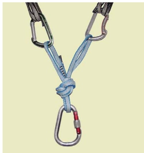
Obr. 54. Spojení dvou bodů pomocí smyčky s vůdcovským uzlem.
