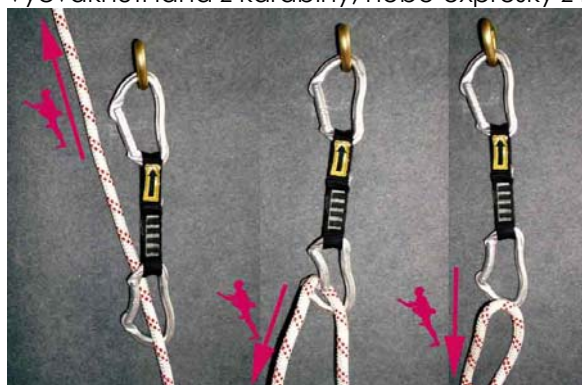
Obr. 10. Mechanismus vycvaknutí lana z expresky při chybném propnutí.
