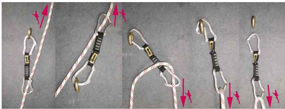
Obr. 11. Mechanismus vycvaknutí expresky z borháku při špatném propnutí lana.
