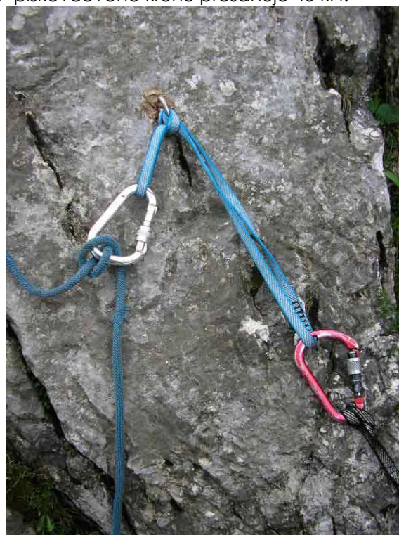
Obr. 39. Uspořádání jisticího staniště v borháku pomocí lodního uzlu, výhodou jsou dvě samostatná oka – jedno pro jisticí pomůcku a druhé pro sebezajištění jističe.
