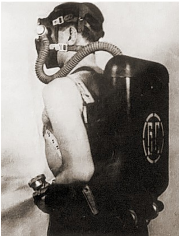
Obr. 51 GC 42, první nezávislý potápěčský přístroj, Amphibie, autor Georse Commeinhese 1942
