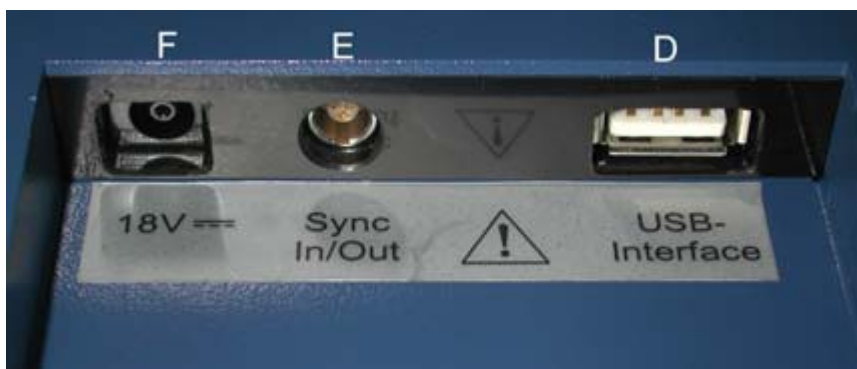
Obr. 6. Konektory připojení plošiny emed-at
