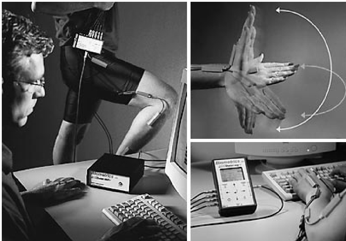
Obr. 104 Ukázka elektrogoniometru a jeho využití při měření změn úhlu v kloubu (Biometrics Ltd, 2010)
